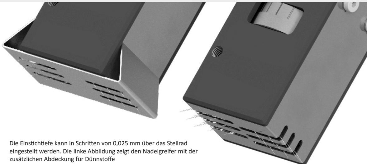
Die Einstichtiefe kann in Schritten von 0,025 mm über das Stellrad eingestellt werden. Die linke Abbildung zeigt den Nadelgreifer mit der zusätzlichen Abdeckung für Dünnstoffe
